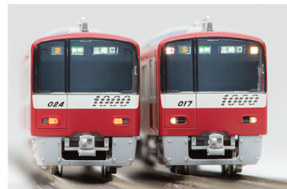
▲行先表示はフルカラーLEDに換装されている(モデルではステッカー選択式)。
