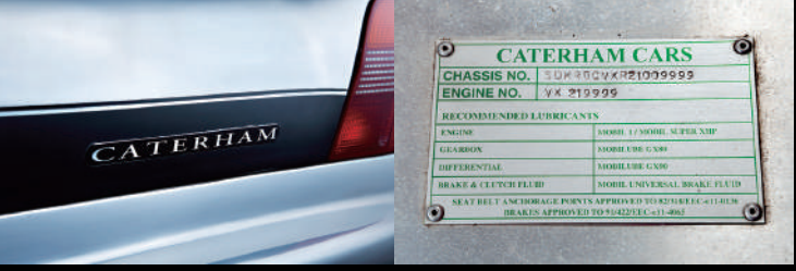
エンジンルームにはシャシーとエンジンナンバーを打刻したプレートを装着。下にはエンジン、ギア、デファレンシャル、ブレーキ&クラッチの推奨オイルが明記され、いずれもモータールとなる。
